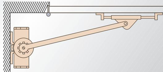
**SÉRIE 9** : Ferme-porte posé en tirant, sur le côté en arrière des paumelles, soit en bas, soit en haut ou à une hauteur quelconque de la porte, de préférence en face d'une traverse horizontale.
